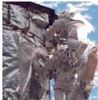
Çarje të mëdha në izolimin shumë-shtresor me pamje diellore të teleskopit “Hubble Space Shield”, u vërejtën gjatë misionit të tij të dytë të shërbimit pas gati 7 vjetësh në hapësirë. Burimi: Townsend, Polimerë me Performancë të Lartë
