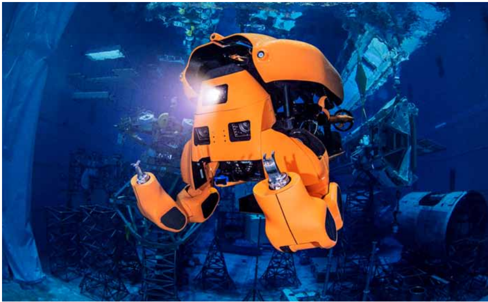
Roboti “Aquanaut” i “Nauticus Robotics” mund të notojë në një destinacion dhe të kryejë detyra me mbikëqyrje minimale, duke kursyer para për operacionet në det të hapur nga pusët e naftës dhe turbinat e erës deri te ffermat e peshkut dhe më shumë. Burimi: “Nauticus Robotics Inc.”
