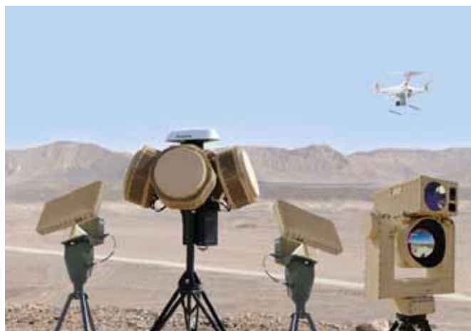
Sistemi Rafael Drone Dome kombinon një grup radarësh 360 gradë për të gjitha kushtet e motit, një sensor radiofrekuece dhe një sensor elektro-optik dhe infra të kuqe, duke rritur mundësinë e zbulimit të kërcënimeve. Imazhi: Rafael
